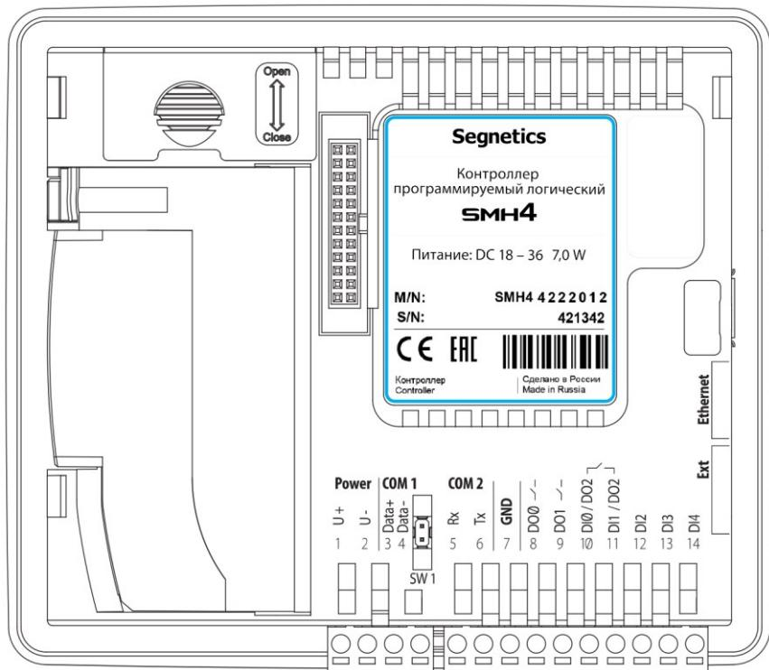
Рис. 1 – Расположение маркировки на задней крышки SMH4 - XXXX-XX-X
