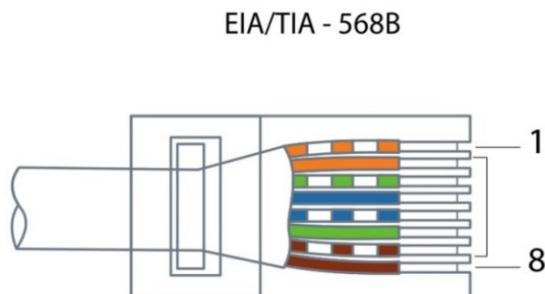
Рис. 54 – Нумерация проводников в кабельном разъёме
