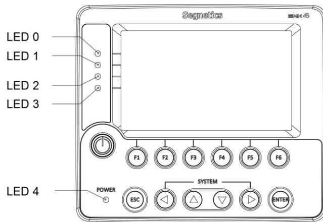
Рис. 12 – Светодиодная индикация
