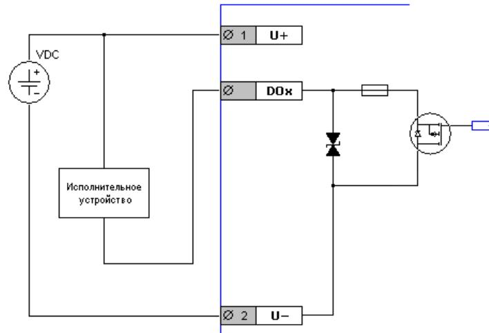
Рис. 39 – Транзисторный выход. Питание контроллера и исполнительного устройства от одного источника тока
