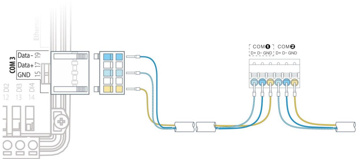
Рис. 53 – Порядок подключения проводов шины MTBus
