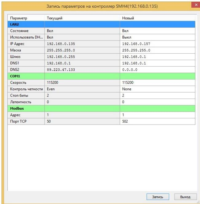
Рис. 50 – Окно записи параметров работы в режиме “Slave” на контроллер
