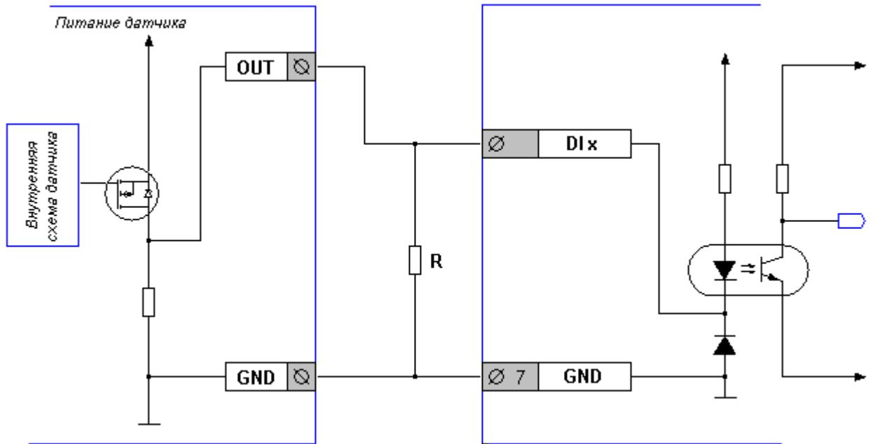
Рис. 36 – Подключение датчиков с выходом «PNP»
