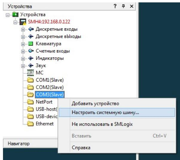
Рис. 51 – Конфигурирование режима работы СОМ3
