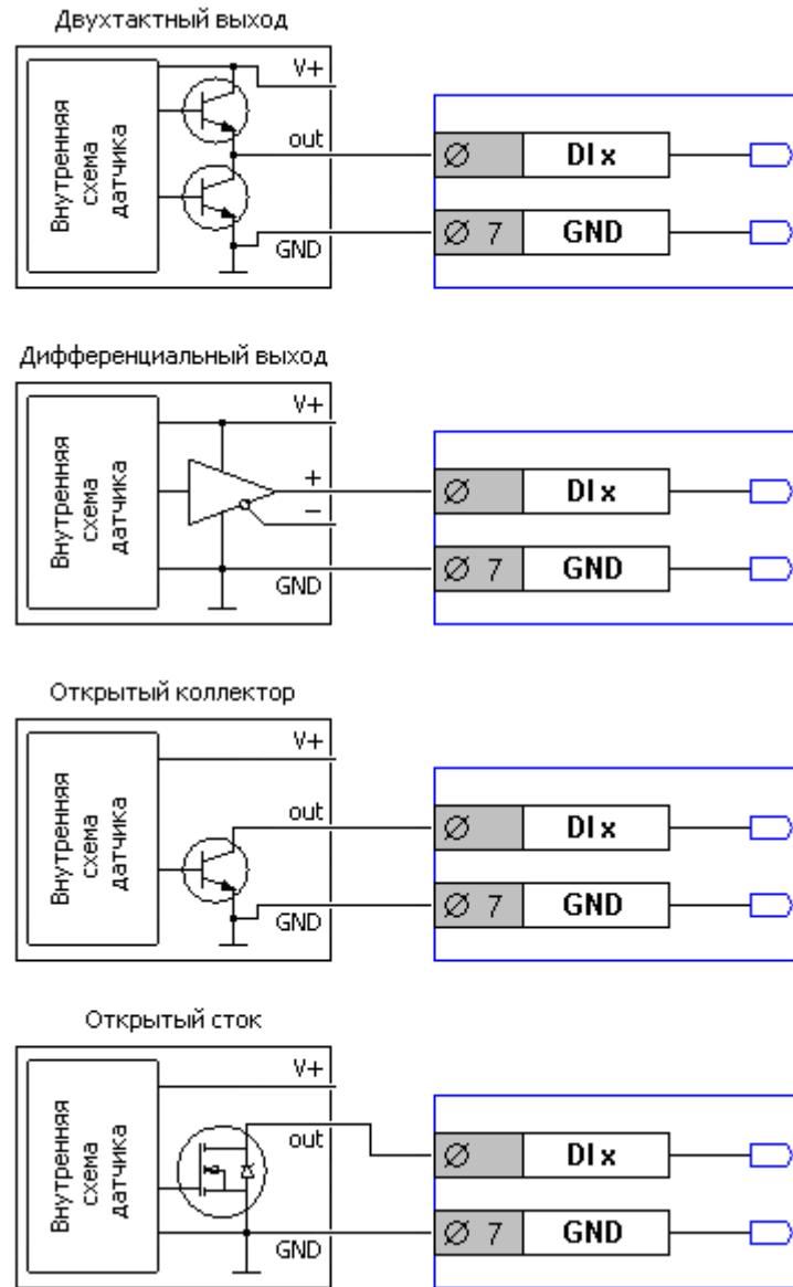
Рис. 35 – Схемы подключения датчиков с различными типами выходов
