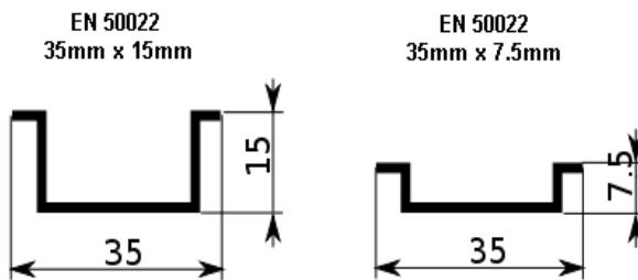
Рис. 17 – Варианты DIN-рейек для монтажа
