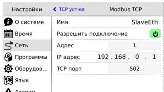
Рис. 72 – Настройки Modbus-TCP slave
