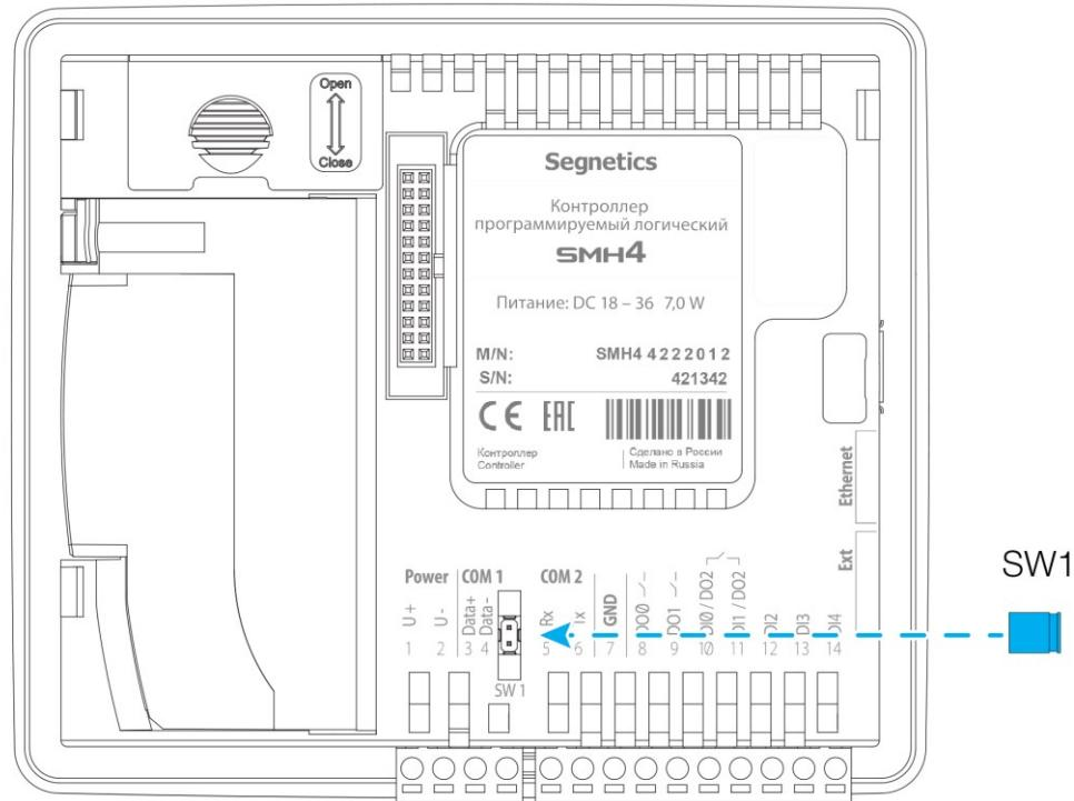
Рис. 43 – Подключение согласующего резистора на контроллере SMH4 - XXXX-XX-X
