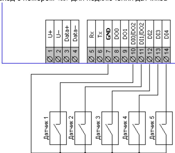
Рис. 34 – Подключение датчиков типа «сухой контакт»
