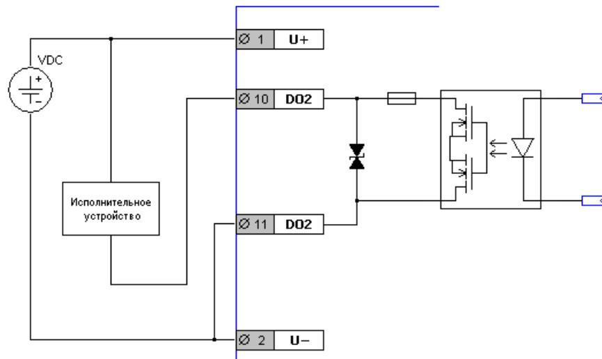
Рис. 40 – Опторелейный выход. Питание контроллера и исполнительного устройства от одного источника тока
