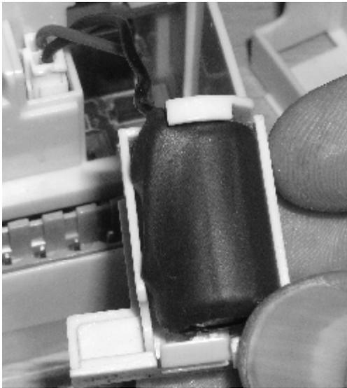
4. Вставьте крышку батарейного отсека в корпус прибора, направьте и уложите провод вдоль корпуса батареи.
