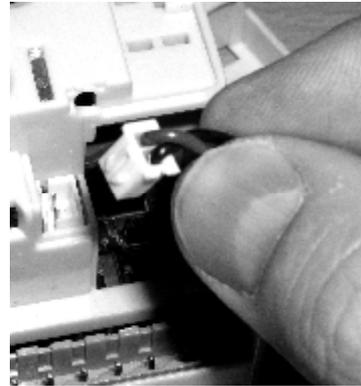
3. Вложите батарейку в крышку батарейного отсека так, чтобы выходящий из кембрика провод находился в вырезе доньшка.
