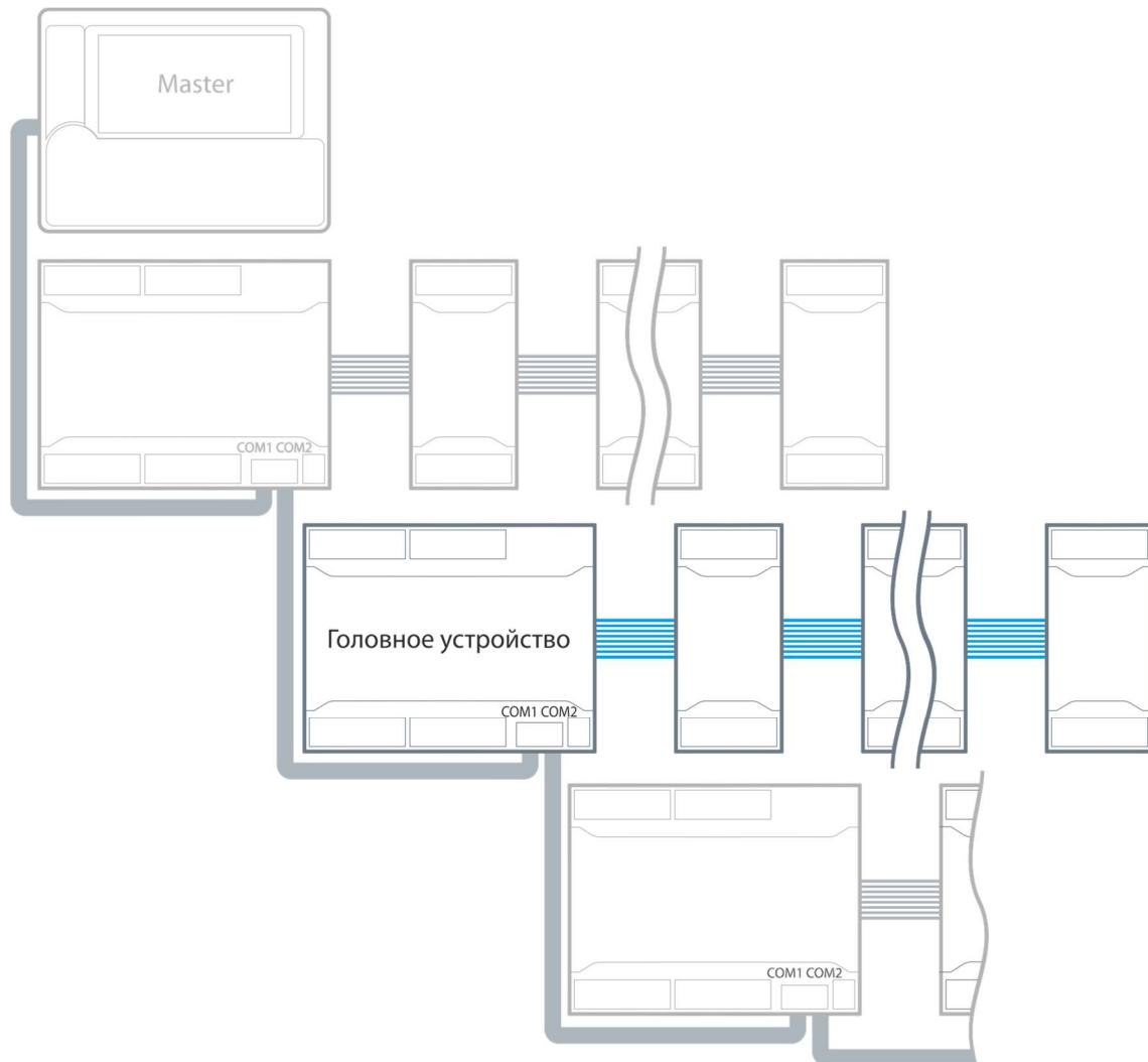
Рис. 13 – Модули MRL в составе шины MTBus
