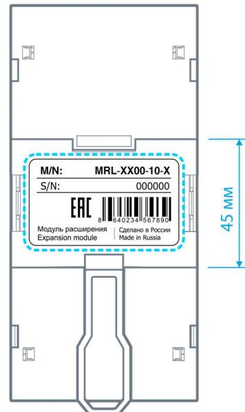
Рис. 1 – Расположение этикетки с кодом заказа и маркировкой
