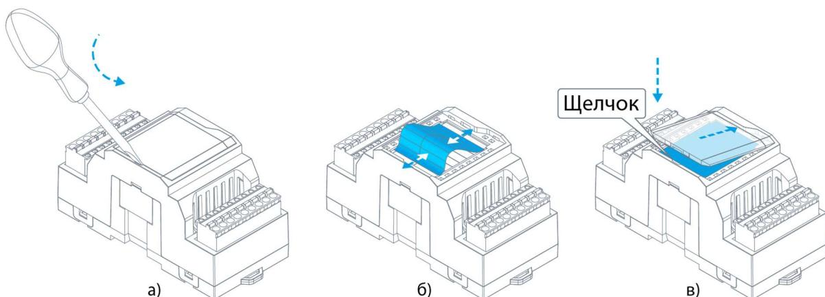
Рис. 9 - Извлечение и установка маркировочного вкладыша
