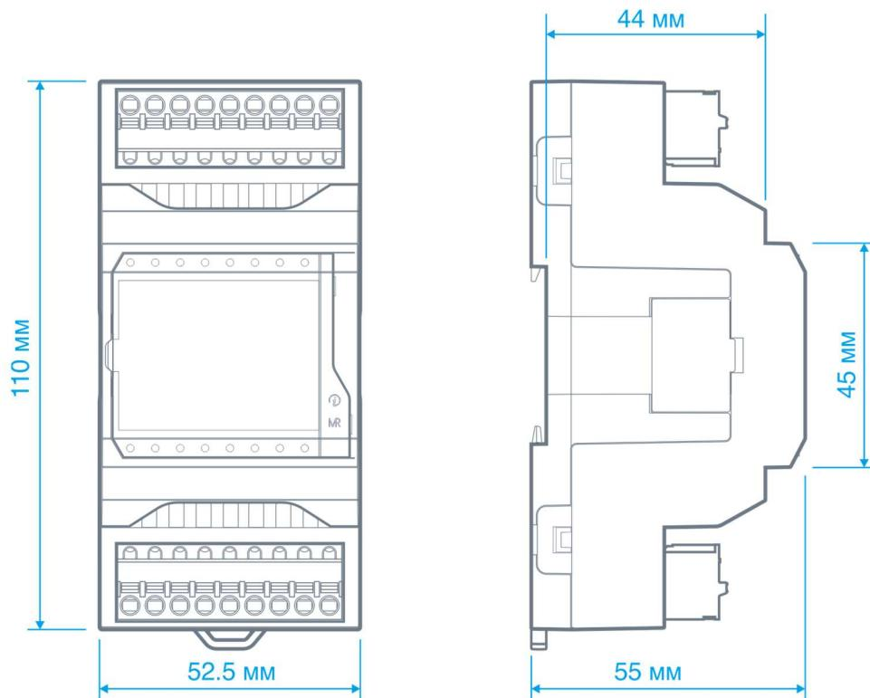
Рис. 5 - Габаритные и установочные размеры
