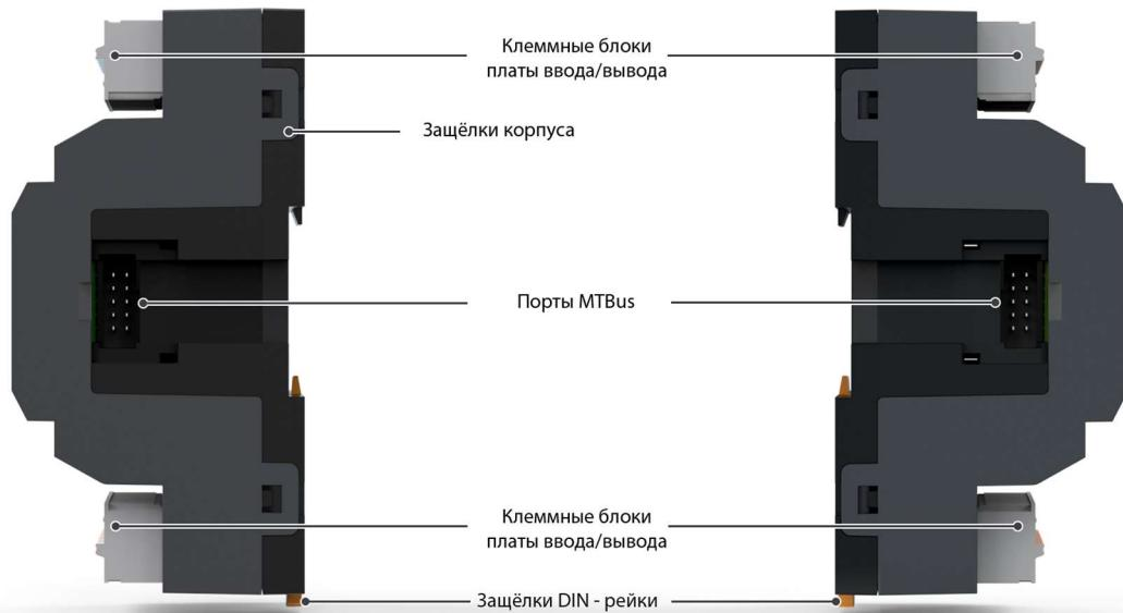
Рис. 4 – Модуль ввода/вывода, виды сбоку
