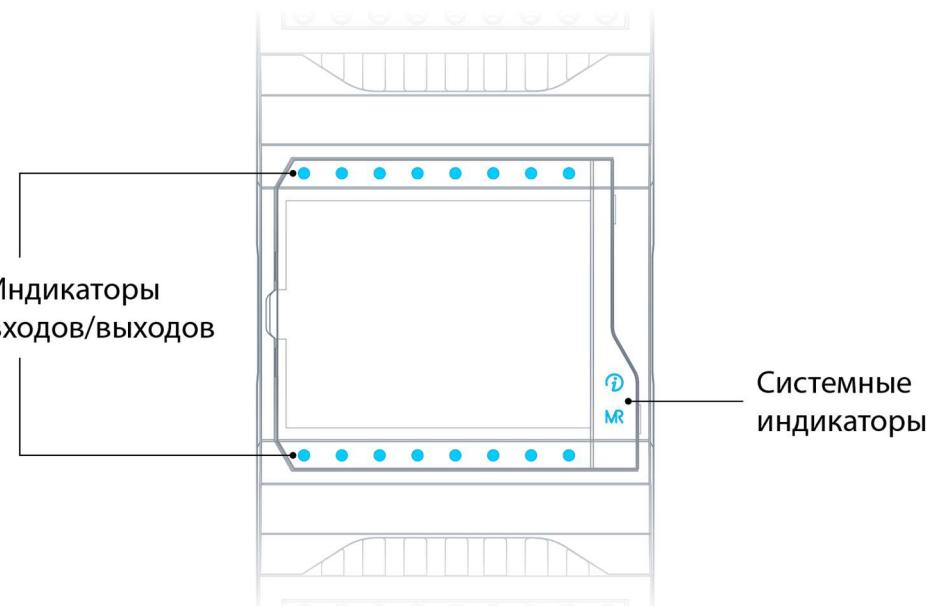
Рис. 11 - Расположение индикаторов на корпусе прибора
