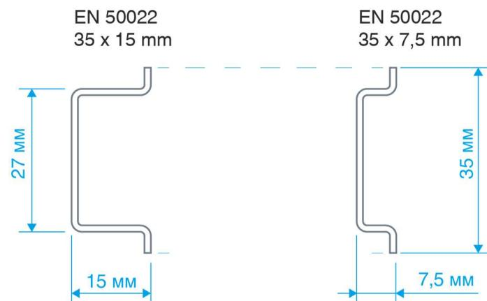
Рис. 6 - Варианты DIN-рейек для монтажа
