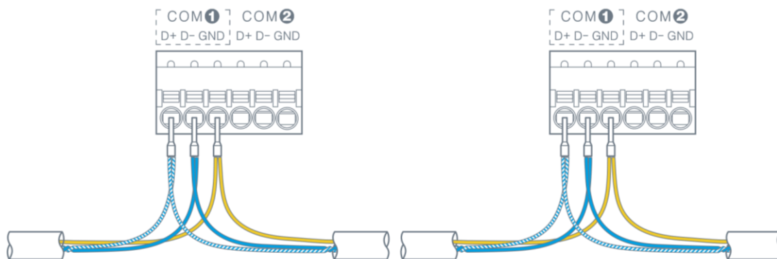
Рис. 28 - Организация подключения проводников RS-485
