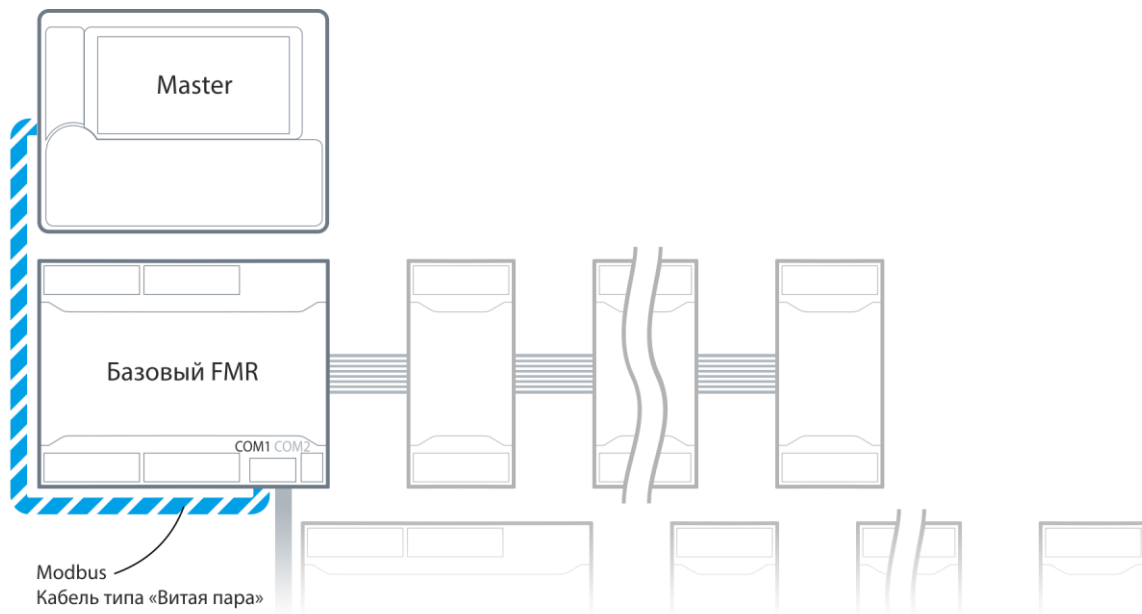
Рис. 26 - Подключение модуля FMR к контроллеру
