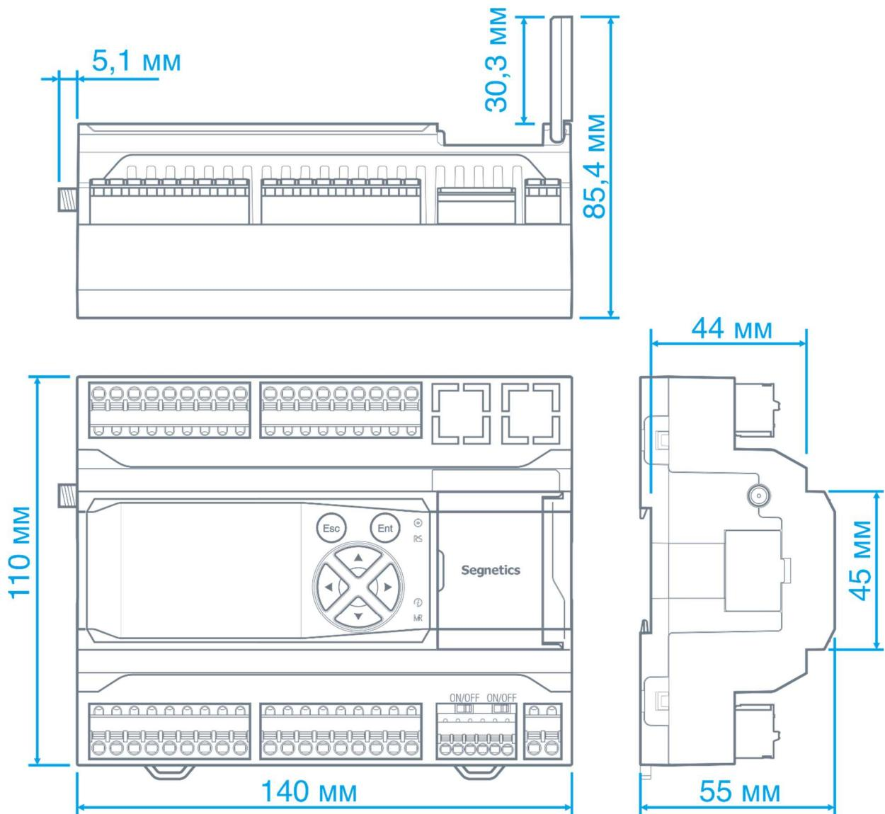
Рис. 52 - Габаритные и установочные размеры контроллера
