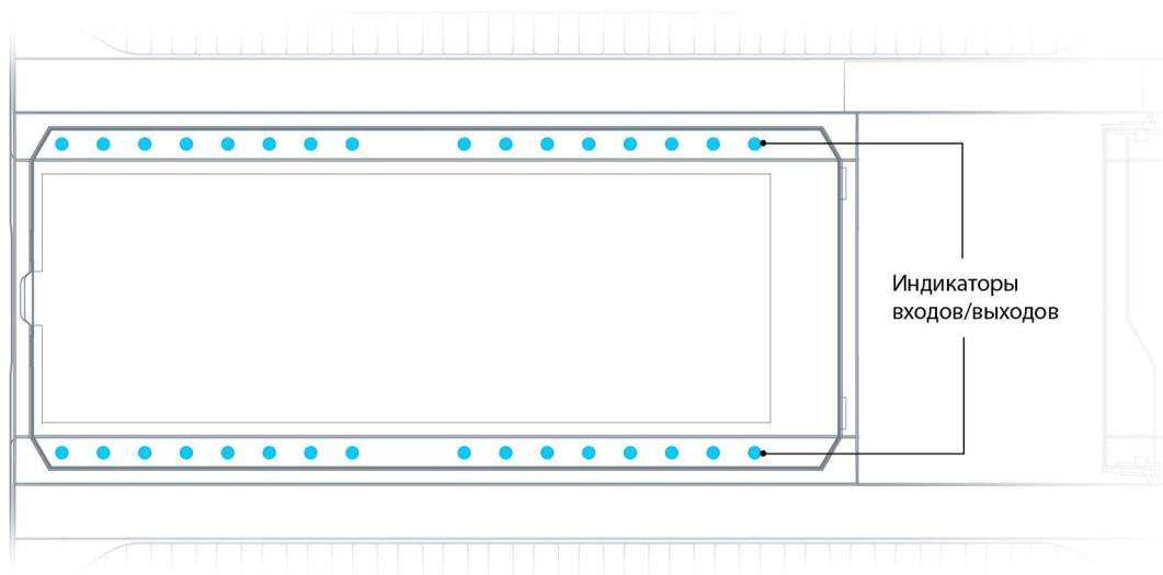
Рис. 9 –Передняя панель контроллера без дисплея
