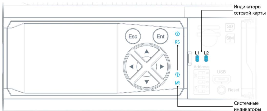
Рис. 5 — Расположение индикаторов на корпусе прибора
