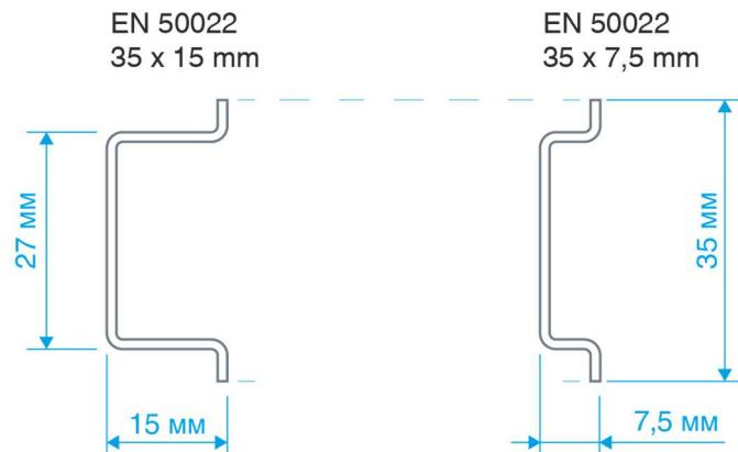
Рис. 50 -Варианты DIN-рейек для монтажа
