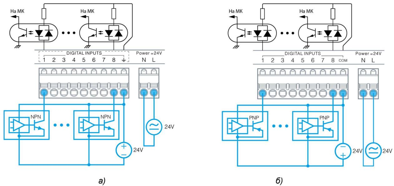
Рис. 12 – Подключение полупроводниковых датчиков с выходами типа «открытый коллектор»
