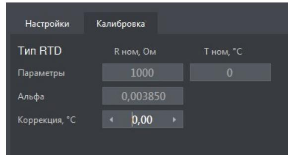
Рис. 60 –Калибровка температурных датчиков
