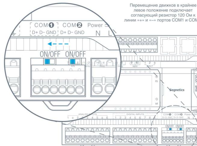
Рис. 22 - Включение терминатора интерфейса RS-485
