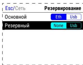
Рис. 37 - Экран настроек резервирования каналов связи
