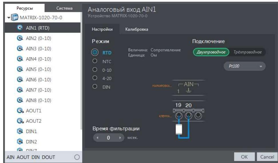
Рис. 59 –Настойка датчика RTD
