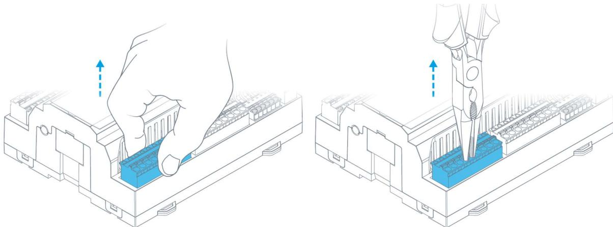
Рис. 4 – Извлечение клеммных блоков.
