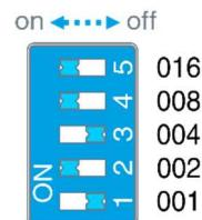
Рис. 7 – Установка адреса на переключателе
