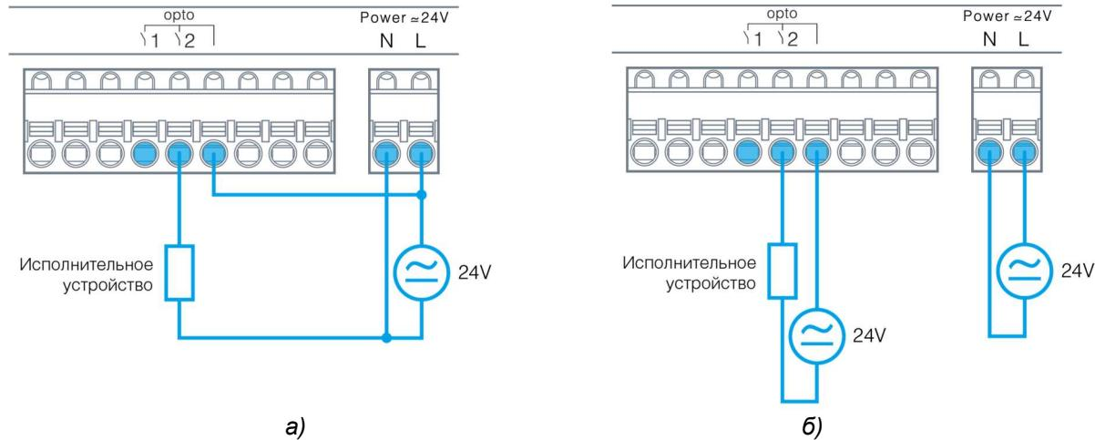
Рис. 15 – Подключение нагрузки к опторелейным выходам и её питающее напряжение:
