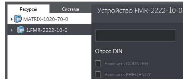
Рис. 65 – Включение частотных и счетных входов
