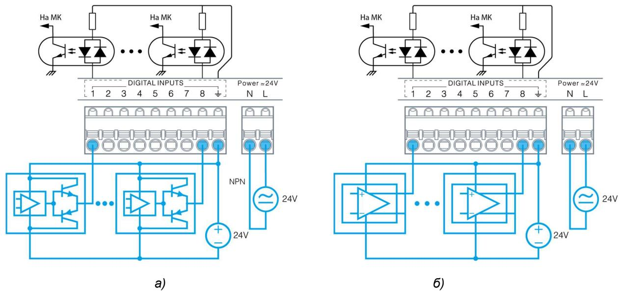
Рис. 13 – Подключение полупроводниковых датчиков с двухтактным типом выхода (а);
