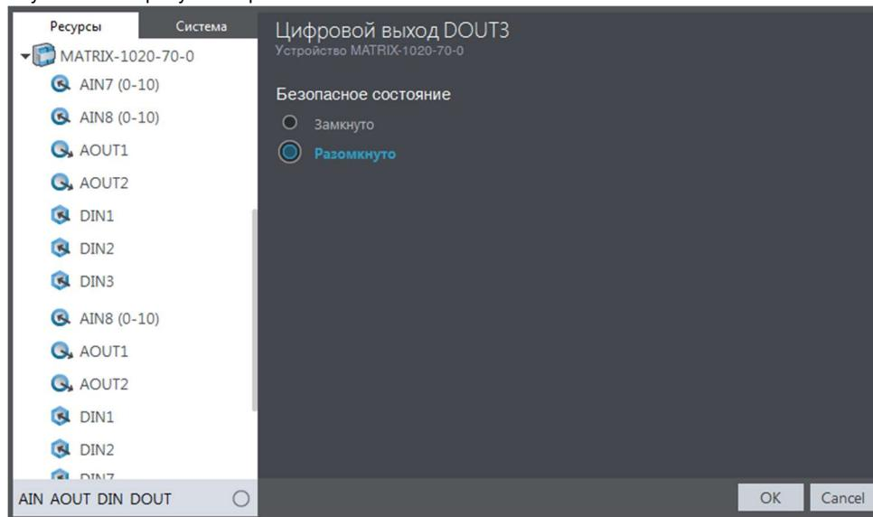
Рис. 63 – Конфигурирование DOUT
